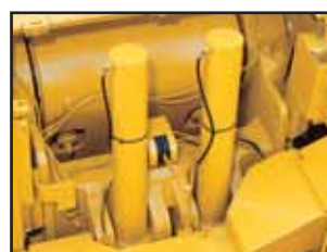
Meccanismo di protezione del frantoio idraulico
