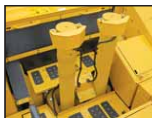
Meccanismo di protezione del frantoio idraulico
