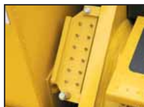
Impianto di lubrificazione centralizzata
