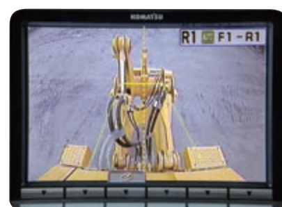
Système de caméra vue arrière complètement intégré
