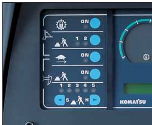
Monitor di controllo dello slittamento dei pattini
