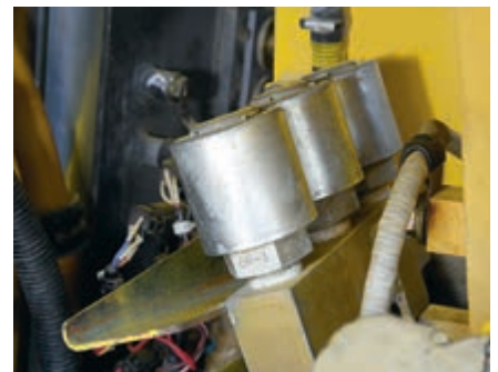
Reniflards ouvrables pour faciliter le contrôle et le nettoyage (en option)
