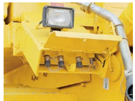
Orifices de vidange distants avec raccords (en option)
