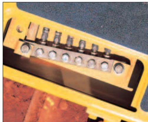
Les prises de test de la pression d'huile pour la transmission sont centralisées du côté droit de la plate-forme de l'opérateur afin de pouvoir y accéder plus aisément.
