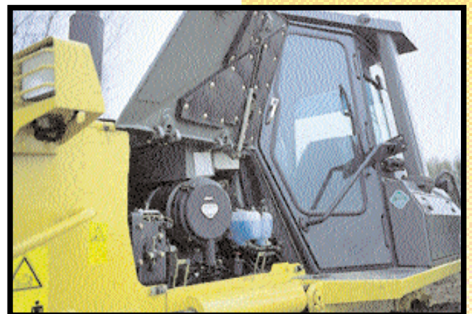
Seitliche Flügelklappen mit Gasdruckfedern, die sich weit öffnen, ermöglichen einen leichten Zugang zum Motor und den Zusatzkomponenten.
