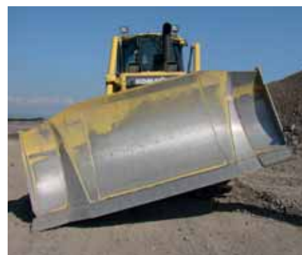
Inclinaison ajustable par système hydraulique: 870 mm
