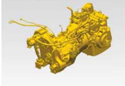
Convertisseur de couple avec verrouillage automatique
