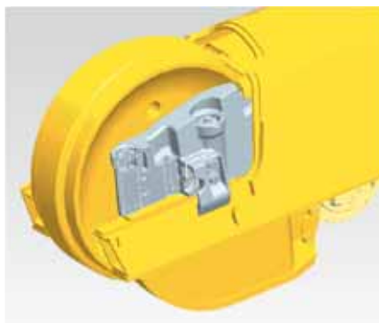
Supporto ruota folle a regolazione automatica
