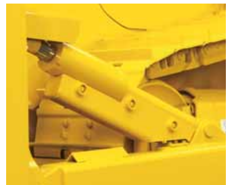
Hydraulikleitungen sind gut geschützt und wenn möglich innerhalb der Struktur verlegt.
