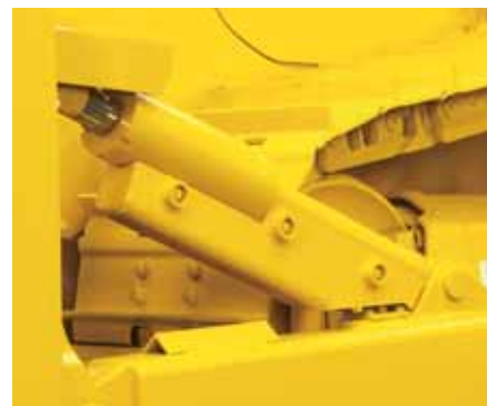
Le tubazioni idrauliche sono prevalentemente integrate nella struttura.
