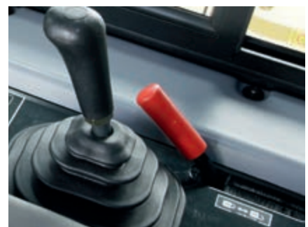
Bedieningshendel voor blad met auto-pitch functie en nieuwe bedieningshendel voor ripper met auto-return functie
