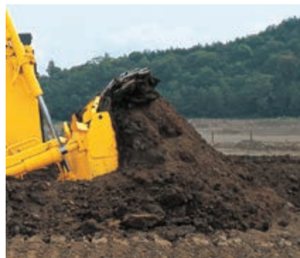
Het Sigmodozer®-blad zorgt voor een optimale vulling en verdeling
