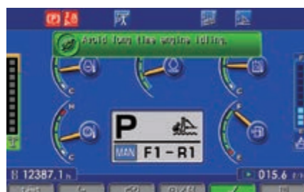
Eco-meter, eco-functie en brandstofmeter
