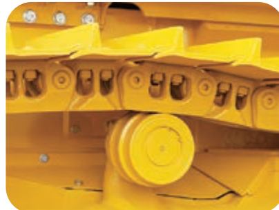
Chaque jonction peut être remplacée à l'aide d'outils standard.
