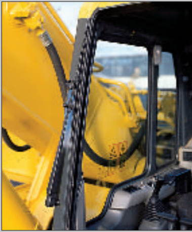
La visibilità è stata migliorata grazie all'attacco diretto del tergicristallo al telaio della cabina, il che ha consentito di aumentare la superficie vetrata disponibile.
