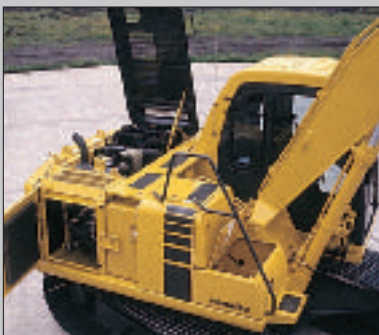
Accessibilità dei componenti da sottoporre a manutenzione.
