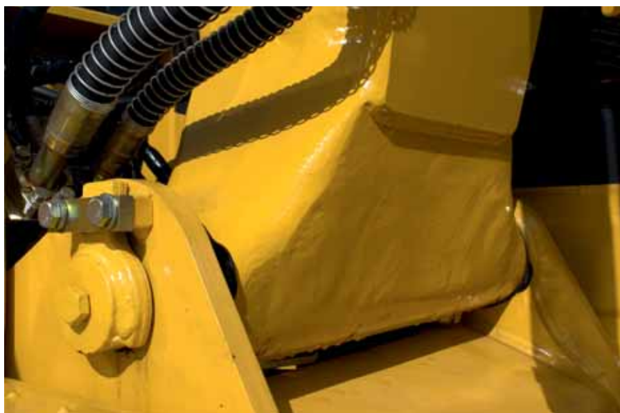
Base del braccio in fusione d'acciaio
