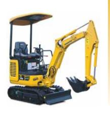
**NET POWER** 11,2 kW / 14,7 HP @ 2.600 rpm
