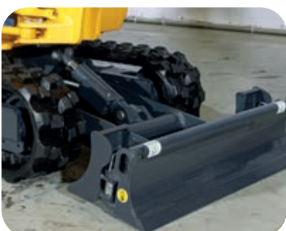
Verstellbares Laufwerk mit klappbarem Schild
