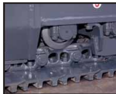
Maglia cingolo con montante Il PC210-7 impiega maglie cingoli con montante che garantiscono una maggiore resistenza e durata
