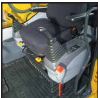
Corsa del sedile: 340 mm – aumentata di 120 mm
