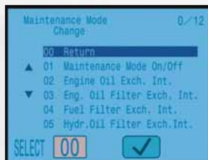
Cambio modalità manutenzione
