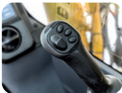
Bekväm, ergonomisk och precis kontroll: styrspakar med proportionell kontrollknapp för redskap
