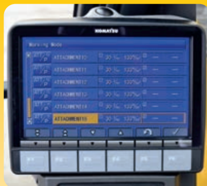
Integrerad redskapsstyrning (Komatsu Integrated Attachment Control, KIAC) för upp till 15 hydrauliska redskap för oljeflöde och tryck (tillval)
