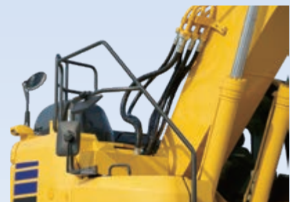
Ledstänger och halkskyddsplåt
