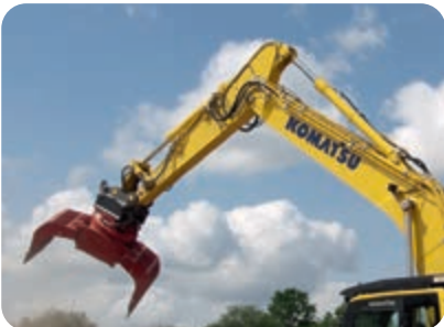
Två extra redskapsledningarna ger tillgång till ett stort antal olika redskap
