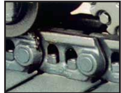
Beim PC230NHD-7 kommen verstärkte Kettenglieder mit Mittelsteg zum Einsatz.
