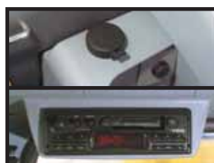
12 Volt Stromversorgung, Kassettenradio
