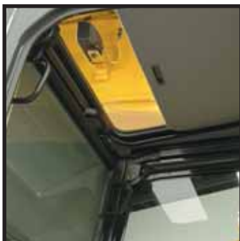
Großes Dachfenster mit integrierter Sonnenblende
