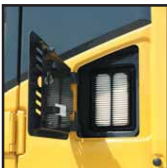
Äußerer Kabinenluftfilter Der Filter der Klimaanlage kann ohne Werkzeug zum Reinigen entnommen werden.
