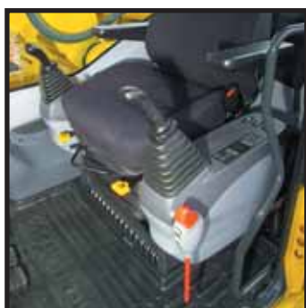
Plage de glissement du siège: 340 mm
