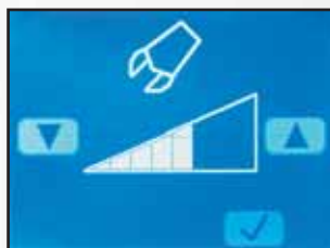
Ecran réglage fin du débit hydraulique en mode A (actif) ou E (économique).
