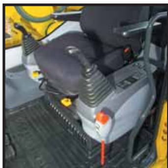
Corsa del sedile: 340 mm – aumentata di 120 mm
