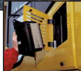
Filtro aria interno cabina La facile rimozione/installazione dell'elemento del filtro aria interno cabina, senza necessità di attrezzi, semplifica le operazioni di pulizia.
