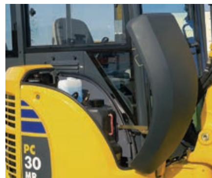
Cofano anteriore: accesso al serbatoio carburante
