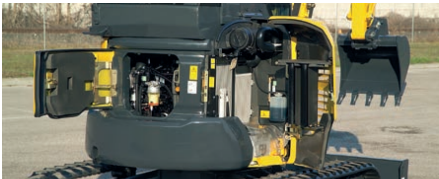
Hinterere Wartungsklappe für schnelle Motorinspektion und Betankung, einfachen Wartungszugang, leichte Reinigung der Kühler und guten Zugang zur Batterie
