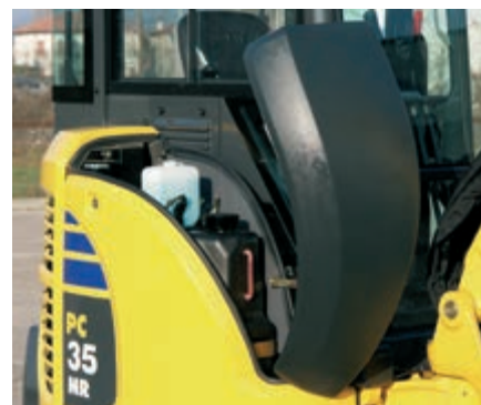
Capot avant: accès aisé au réservoir de carburant
