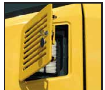
Äußerer Kabinenluftfilter Einfaches Reinigen des Filters der Klimaanlage. Der Filter der Klimaanlage kann ohne Werkzeug zum Reinigen entnommen werden.
