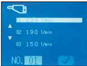
Einstellung Hydraulikölstrom in der Hammer-Betriebsart (B)
