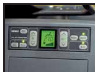
Klimatronic mit Umluft- und Defrosterbetrieb
