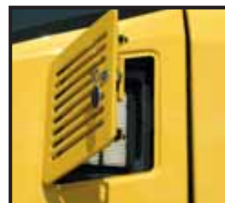
Filtro aria interno cabina
