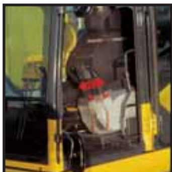
Corsa del sedile: 340 mm – aumentata di 120 mm
