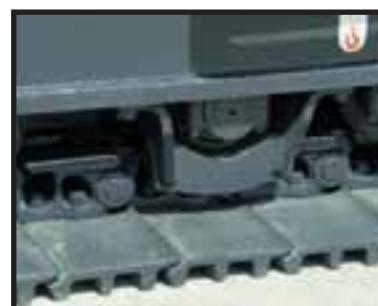
Maglia cingolo con montante Il PC450-7 impiega maglie cingoli con montante che garantiscono una maggiore resistenza e durata
