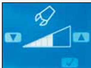
Regolazione della portata idraulica degli accessori in modalità A (Active) o E (Economy).
