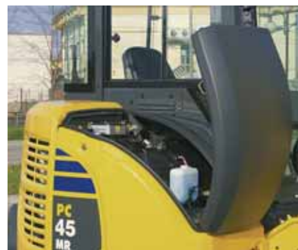
Cofano anteriore: accesso al serbatoio carburante
