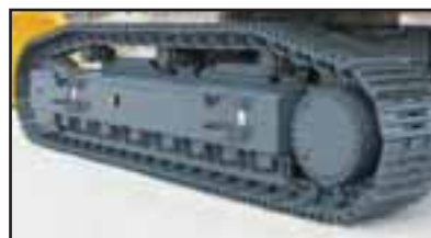
Laufrollenschutz über die gesamte Laufwerkslänge (Option)
