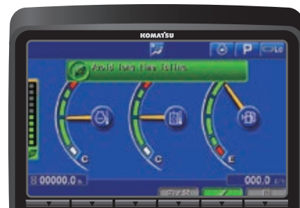
Eco-mätare, eco-guidning, tomgångsvarning och justerbar tomgångsavstängning hjälper att minska bränslekonsumtion
