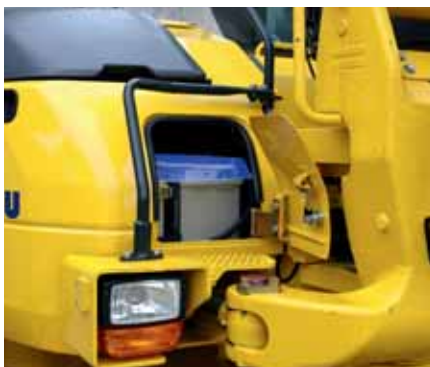
Vom Boden aus erreichbare Batterie
