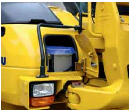
Accesso alle batterie da terra
