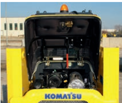
Die weit öffnende Motorhaube ermöglicht eine schnelle Motorinspektion.
