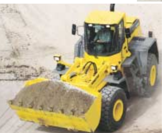
WA380-3 beim Load & Carry-Einsatz
