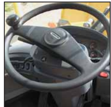
Piantone dello sterzo completamente regolabile
