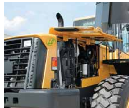
Einfacher Zugang zu den Wartungspunkten
