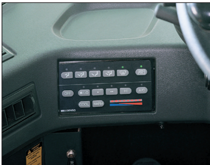
Die Klimaanlage mit 5 verschiedenen Belüftungsarten sorgt für einen stressfreien und produktiven Arbeitstag
