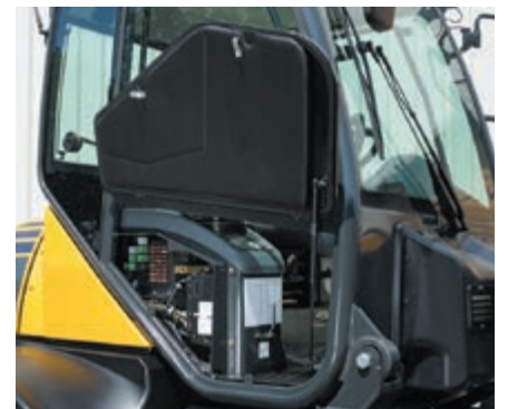
Capot latéral pour un accès facilité lors de la maintenance et nettoyage intérieur
