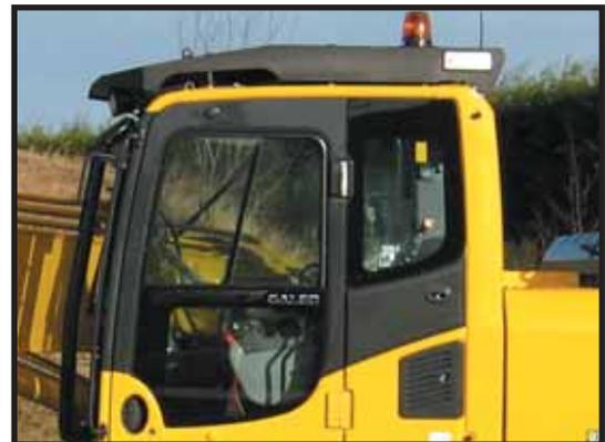
ISO 10262 FOPS Stufe 2 Dach- und Frontschutz (Option)
