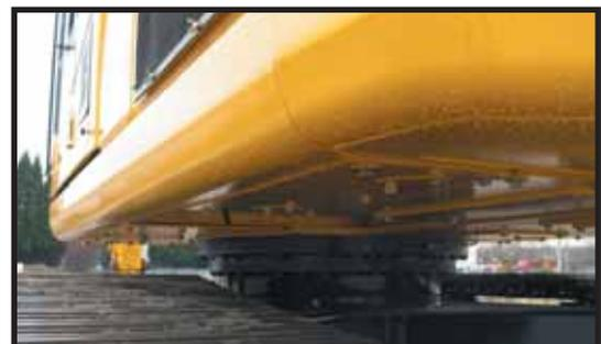
Der HD-Bauchschutz am Oberwagen bietet optimalen Schutz vor Beschädigungen von unten.
