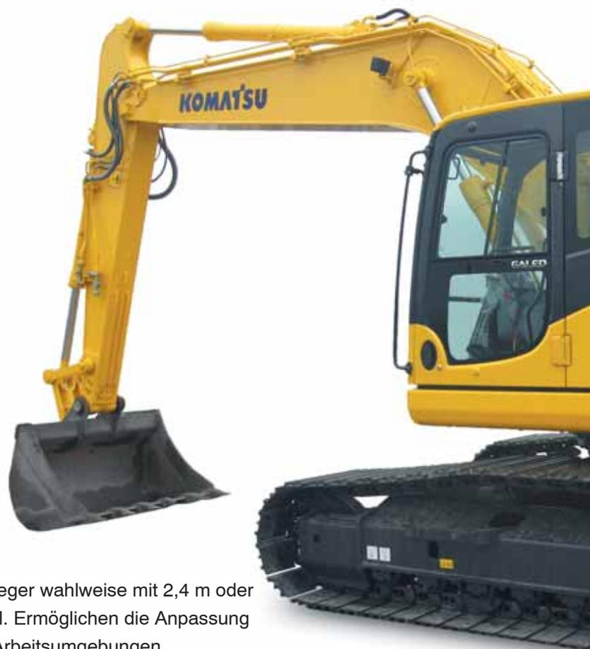
Monoblockausleger wahlweise mit 2,4 m oder 2,9 m Löffelstiel. Ermöglichen die Anpassung an besondere Arbeitsumgebungen.
